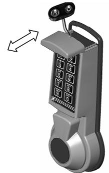
die Führung gleiten lassen und bis zum Anschlag aufschieben.
